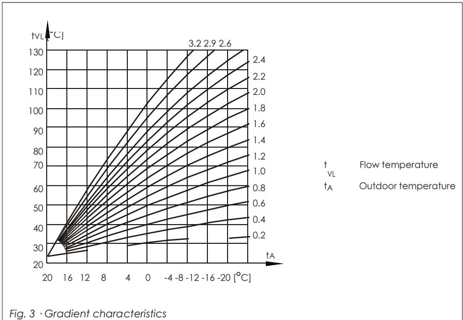
Fig. 3 · Gradient characteristics
